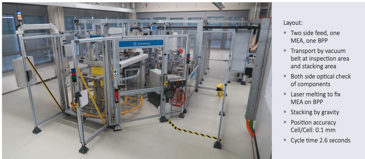
Abbildung 13 Versuchsanlage für die Montage von 30 000 Stacks/Jahr
